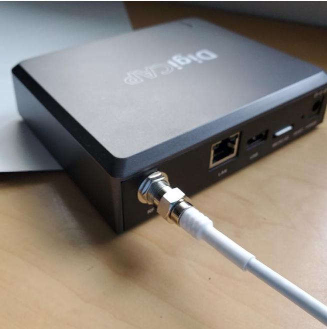
2.1 Enrosca y conecta el cable de la antena con el equipo DigiCap
