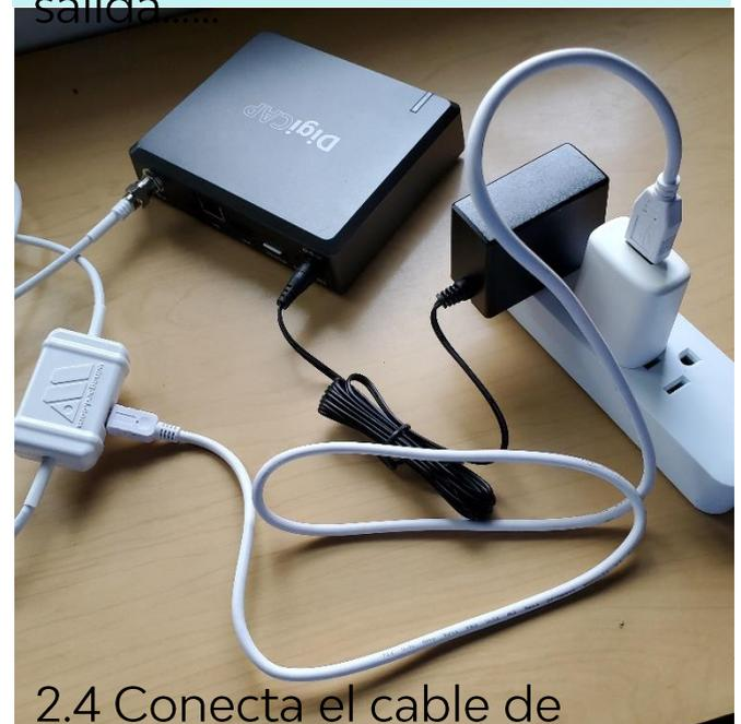
2.4 Conecta el cable de alimentación al equipo DigiCap y enchufa los dos en el tomacorriente o en la regleta de enchufes.
